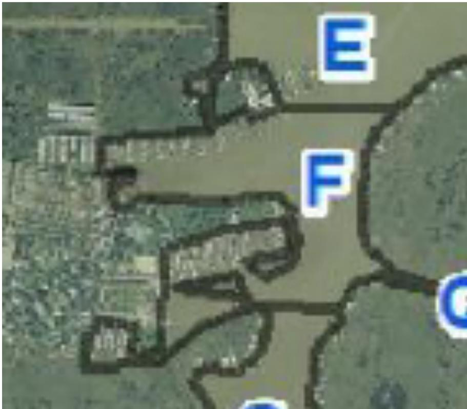
Im Sektor F, der eine Fläche von 145700 m<sup>2</sup> aufweist, liegen mit Stand Juli 2020 63700 m<sup>3</sup> Nassschlamm. Seit 2011 ist diese Menge um 11.900 m<sup>3</sup> angewachsen.
